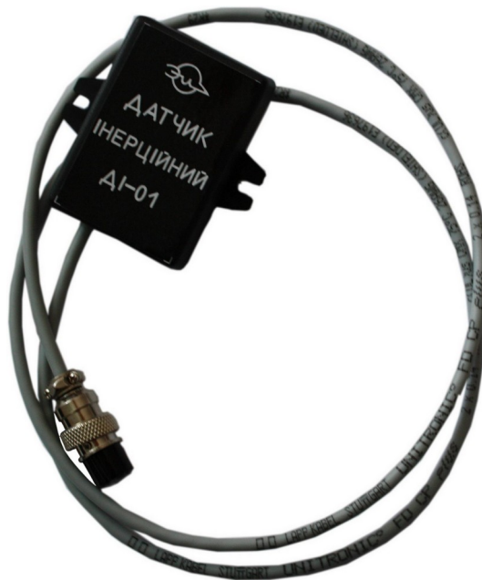
Рис. 5 - Датчик ураження мішені (ДУ)
