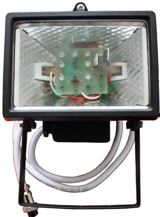
Рис. 7 – Ліхтар для підсвічування мішені (ЛП) та світовий імітатор
