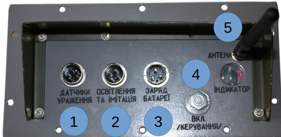
Рис. 3 – Панель електронного блоку управління
